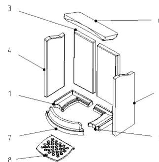
Numerazione dei refrattari = ordine da seguire per il montaggio!
