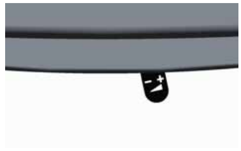
Abb. 4.8 Verbrennungslufschieber ganz nach rechts geschoben - Verbrennungsluft komplett geöffnet
