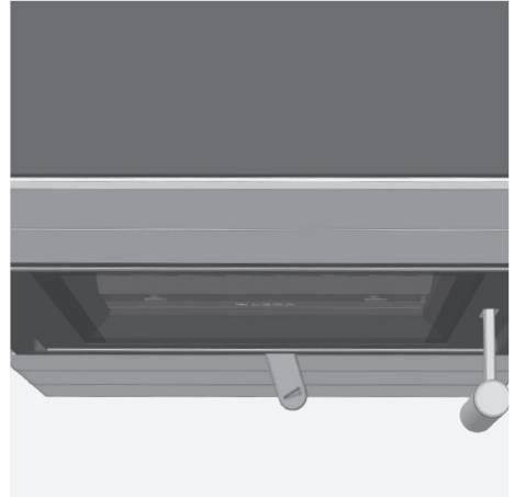
Abb. 4.6 Verbrennungslufthebel ganz rechts, Verbrennungsluft komplett geöffnet, Anheizen
