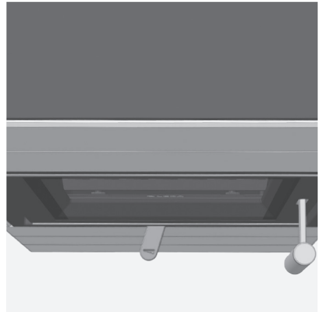
Abb. 4.3 Verbrennungslufthebel ganz links, Verbrennungsluft geschlossen
