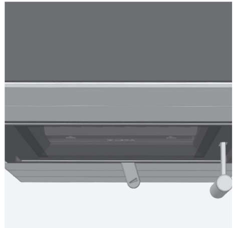
Abb. 4.11 Verbrennungslufthebel ganz rechts, Verbrennungsluft komplett geöffnet, Anheizen
