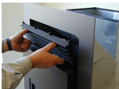
Frontgitter abschrauben und entfernen.
